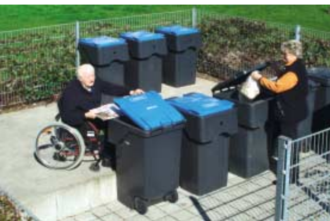
Ein gut geplanter Müllcontainerplatz: Die erhöhte Anfahrt macht das Öffnen der Deckel leicht für alle. Arnberg-Unterhüsten
