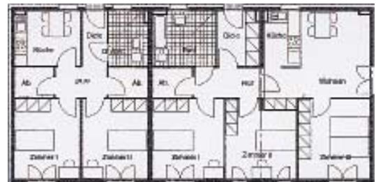
Eine intelligente Grundrisslösung: Die gleich großen Individualräume lassen flexible Nutzungen zu. Albrecht-Dürer-Str., Oelde
