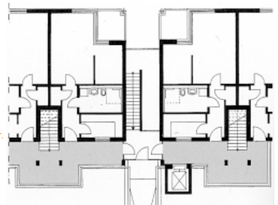
Hier wird der Laubengang zum erweiterten Wohnbereich: Platz für Begegnungen und Spielraum für Kinder. Einbrunger-Str., Düsseldorf-Wittlaer
