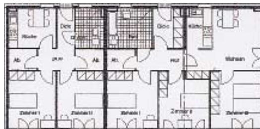
Eine intelligente Grundrisslösung: Die gleich großen Individualräume lassen flexible Nutzungen zu. Albrecht-Dürer-Str., Oelde
