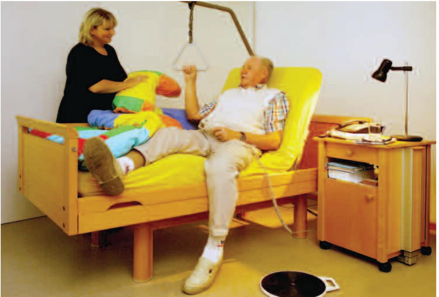
Von allen Seiten zugängliches Pflegebett mit elektrisch verstellbarem Rückenteil mit Umsetzhilfe in Form des Bettgalgens, erreichbare und ausreichend ausgeleuchtete Ablagefläche mit Hausnotruftelefon, Drehteller als Umsetzhilfe – nur mit Unterstützung brauchbar
